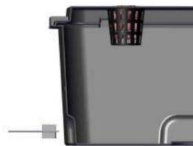
Utilisez la perceuse de 30 mm de diamètre fournie pour percer le trou d'arrivée d'eau aussi bas que possible près du fond du réservoir pour vous assurer que l'eau s'écoule au fond du réservoir.
