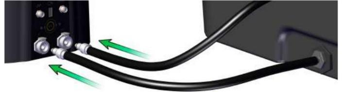
10. Connecter la sonde de niveau/température câble.
