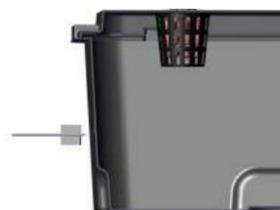
Percez le trou d'arrivée d'eau à un point au-dessus du niveau d'eau maximum.
