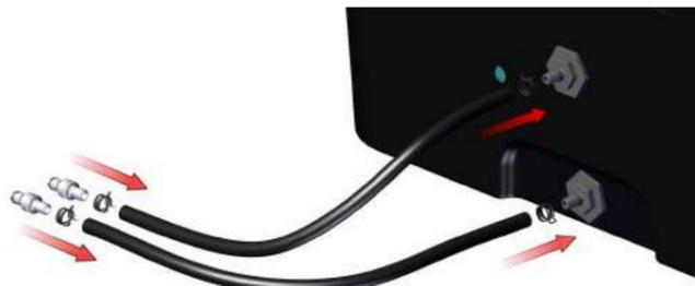
9. Connectez les tuyaux d'alimentation de la cuve au NIDO ONE V2 comme suit : tube Tub OUT vers l'entrée NIDO ONE V2 IN et tube Tub IN vers l'entrée NIDO ONE V2 OUT.
